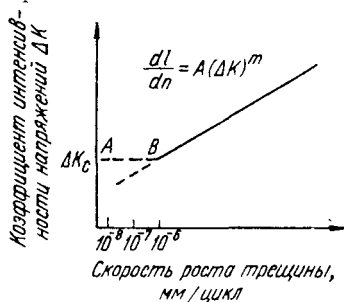
Рис. 4. Скорость роста усталостной трещины в зависимости от коэффициента интенсивности напряжения
