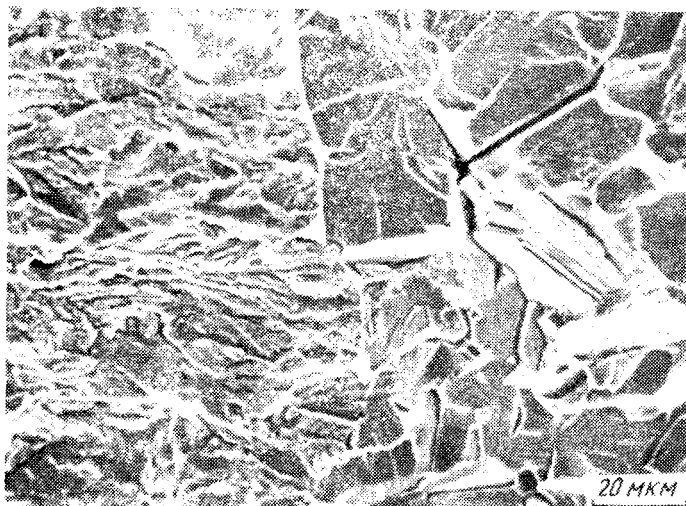
Рис. 5. Микрофотография границы раздела между усталостной трещиной и отрывом в стали 1020 при -196^{\circ}\text{C} , полученная на сканирующем электронном микроскопе
