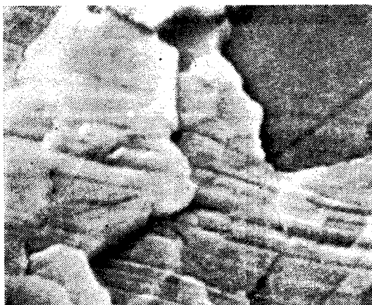
Рис. 3. Вращение зерен и скольжение по границам зерен в сверхпластично деформированном эвтектоидном сплаве Al—Zn, выявленное методом сканирующей электронной микроскопии
