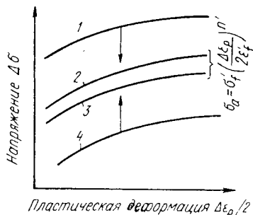
Рис. 2. Кривые деформационного упрочнения при циклическом (2, 3) и монотонном (1, 4) нагружении материала:
