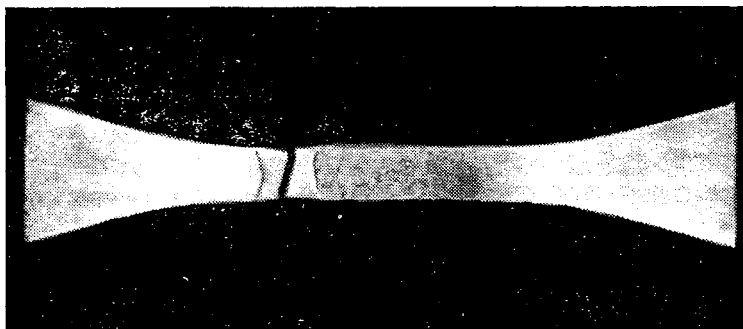
Рис. 11. Образец из низкоуглеродистой стали с размером зерна 1,7 мкм после разрыва
