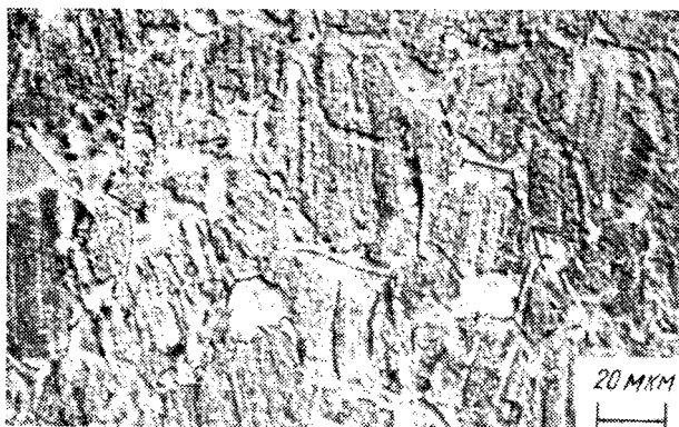
Рис. 4. Микроструктура сплава Mg+6% Zn+0,5% Zr после 100%-ной деформации растяжением при 450°С с начальной скоростью \dot{\epsilon} = 2 \cdot 10^{-3} \text{ мин}^{-1} . Ось растяжения направлена вертикально [15]
